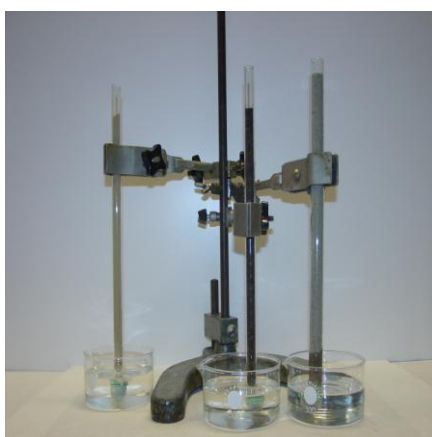
zanurzenie rur z glebami w wodzie
